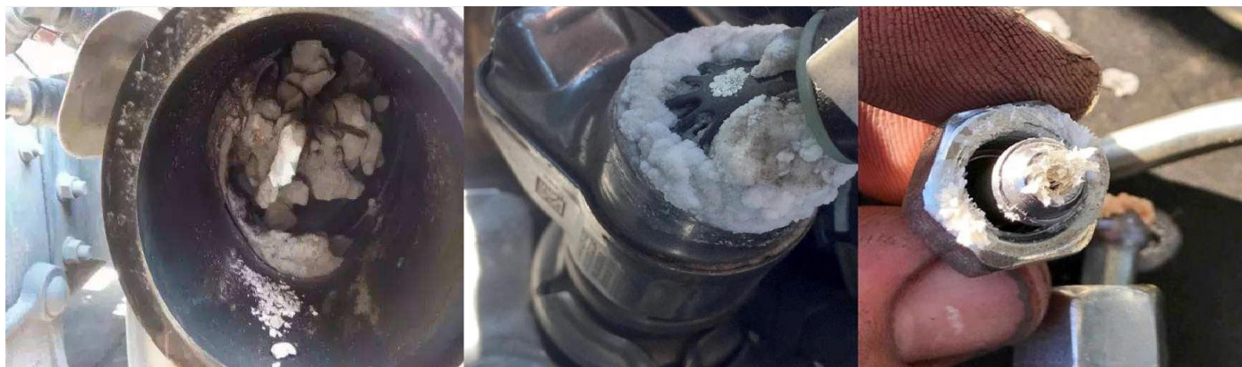
Exemplo de componentes e catalisador SCR obstruídos com cristais
